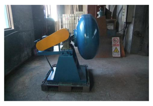
球磨机如何做好空车试运转: (一)空运转的连续运转时间不少于12-24小时,运转中发现问题应及时解决。(二)空运转试机正常即可进行负荷试运转,负荷试运转应分阶段进行,负荷运转中应视排料情况进行喂料,避免钢球和筒体衬板不必要的磨失和损坏。1、加入适当物料和1/3数量的钢球(大装球量参看球磨机总图)试运转12-24小时。2、加入至2/3数量的钢球运转24-48小时。3、根据球磨机排料情况,合格产品的产量,参照同类选矿厂球磨机的实际装球量,确定本台球磨机的合理装球量,进行不少于72小时的试运转。(三)上述负荷量的增加和试运转时间的长短,以大小齿轮和减速机齿轮的跑合情况(温升、噪音、齿面接触等)为依据进行确定。在齿面接触精度没有达到设计要求前,不得满负荷运转。(四)试运转中冷却、润滑系统应工作正常,主轴承、传动轴承、减速机温度应正常。(五)装入2/3数量的钢球试运转24-48小时后,应检查并再次拧紧全部螺栓。(六)试运转工作要认真做好各项记录。陕西球磨机厂淄博祥耀新材料科技有限公司秉承团结、奋进、创新、务实的精神,诚实守信,厚德载物。
