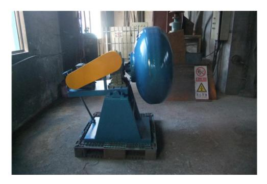
选矿球磨机筒内装有研磨体:从选矿球磨机的内部结构方面说起,它是由进出料、简体、磨头和空心轴这几个部分组成的,筒内装有研磨体,筒体为钢板制造,有钢制衬板与简体固定,研磨体一般为钢制圆球,再以不同直径和一定比例装入筒中,研磨体也能够使用钢段。当筒体旋转的时候,物料和磨球在离心力的作用下,贴近在衬板上,由于摩擦力的原因,筒体将物料和磨球带小编到一定高度,在这个时候在重力作用下,磨球和物料一起下降,磨球将物料击碎,同时物料相对衬板发生滑动摩擦,对物料产生研磨作用,就能够达到粉磨物料的目的。在日常操作选矿球磨机的过程中,单位时间内喂料量变化太大,造成磨辊磨环的工作不稳定,情况严重的话,会使磨辊磨环掉落,遇到这种情况就需要及时停止工作,对设备进行的检查,排除安全。
